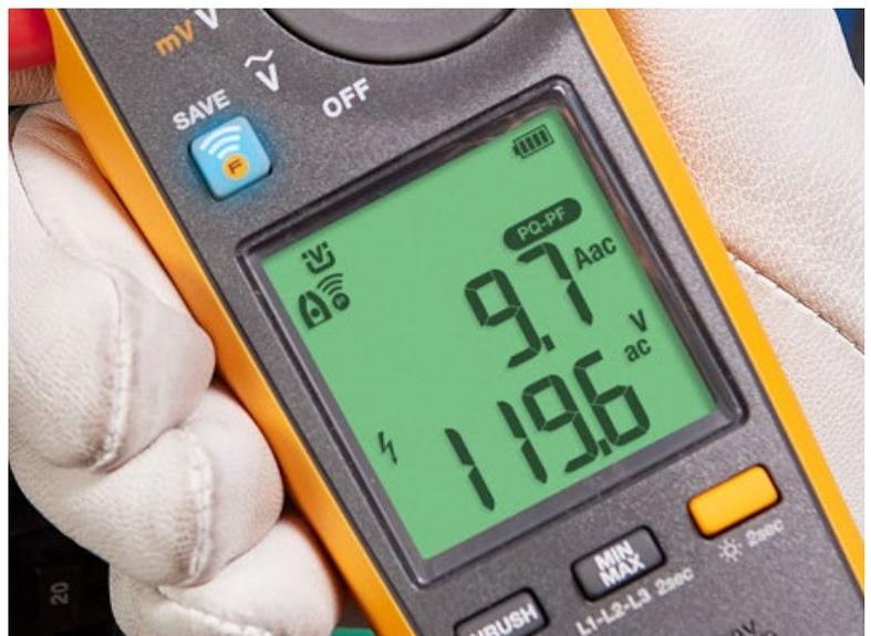
O 378 FC inclui um teste de qualidade da alimentação que fornece indicação rápida se há um problema na energia de entrada ou no equipamento.
