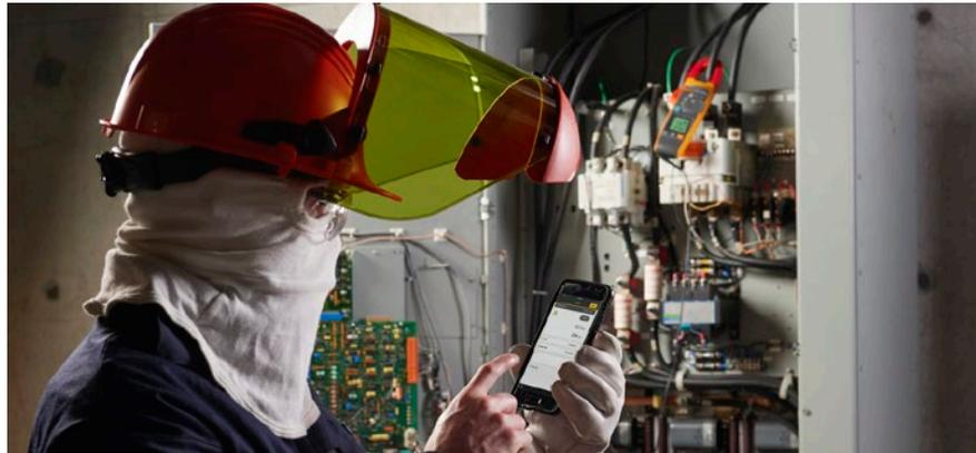
O Fluke Connect permite que as medições sejam enviadas para um smartphone para registro, colaboração e análise.
